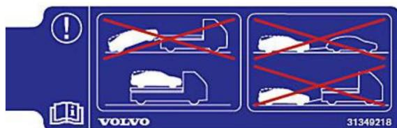
No se permite remolcar el EX90. Durante el remolcado del vehículo, deberá desplazarse la menor distancia posible, a una velocidad máxima de 10 km/h según la carga. Ninguna de las ruedas puede estar en contacto con el suelo durante el remolcado. De esta forma, se evita dañar el sistema de transmisión y los motores eléctricos. El ojal de remolcado puede utilizarse para tirar del vehículo y colocarlo en la plataforma del vehículo de recuperación.
