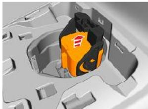
Siga las indicaciones relativas a batería de alta tensión, desconexión; retire la tapa del tapiz ubicada en la parte inferior, a los pies de la segunda fila de asientos al interior del habitáculo.
