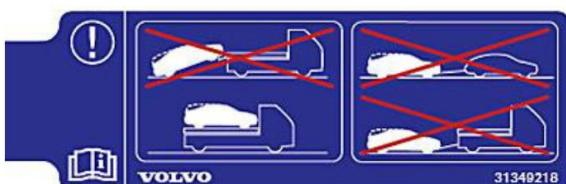
No se permite remolcar el XC60 T8. Durante el remolcado del vehículo, deberá desplazarse la menor distancia posible, a una velocidad máxima de 10 km/h según la carga. Ninguna de las ruedas puede estar en contacto con el suelo durante el remolcado. De esta forma, se evita dañar la caja de cambios y el motor eléctrico. El ojal de remolcado puede utilizarse para tirar del vehículo y colocarlo en la plataforma del vehículo de recuperación.
