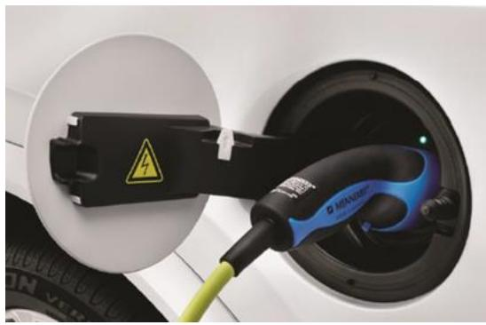
Existe señalética en zonas del vehículo las cuales advierten de la presencia de alta tensión, como ejemplo la tapa de conexión eléctrica
